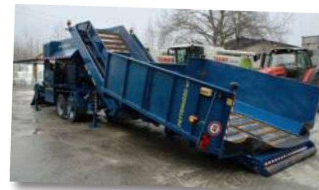
● Il cantiere della Goweil è lungo più di 20 metri e costituito da tre settori: caricamento, pressatura e fasciatura.
