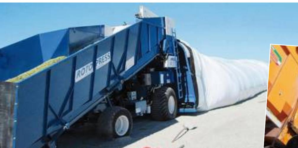
● Due immagini del sistema Rotopress dell'Apiesse, che permette di realizzare tunnel di insilato alti fino a 3,6 metri. Ogni sacco può contenere fino a 120 tonnellate di prodotto, con una lunghezza massima di 60 metri. Il caricamento dell'insilato avviene direttamente dal carro, oppure attraverso una pala o un caricatore telescopico. La capacità di lavoro è di circa 100 tonnellate l'ora.
