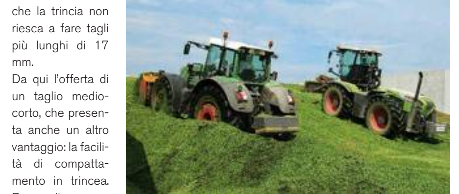
● Per compattare meglio un prodotto al 44% di umidità i Rosina sono intervenuti con due mezzi su ogni trincea. Ciò nonostante in alcuni casi sono insorti problemi di muffa.
