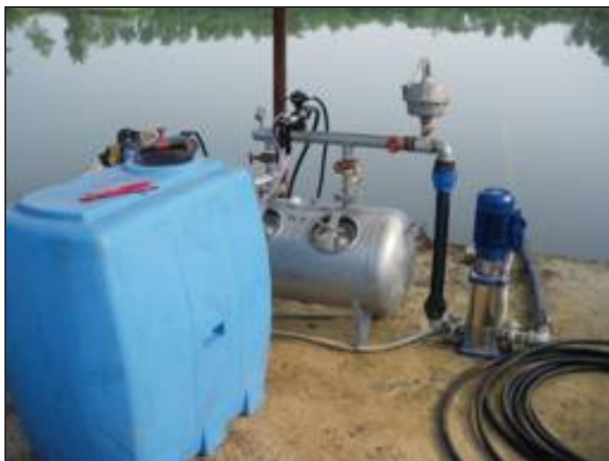
[ Sistema di fertirrigazione con prelievo da bacino aziendale.
