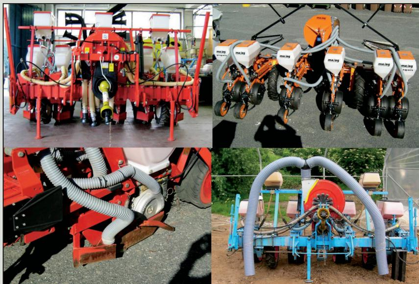
[ **Kit anti-deriva.** L'applicazione del *dual pipe deflector* per il convogliamento dell'aria a terra o nell'assolcatore nei tre modelli di seminatrice pneumatica studiati presso l'Università di Torino.
