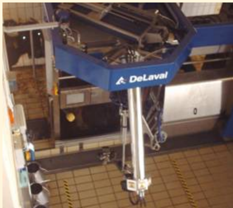
● Il braccio meccanico del robot provvede automaticamente all'operazione di mungitura.
