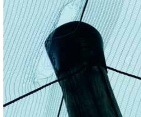
▲ Fig. 3 - Usura della rete antigrandine bianca nella zona superiore della copertura.
