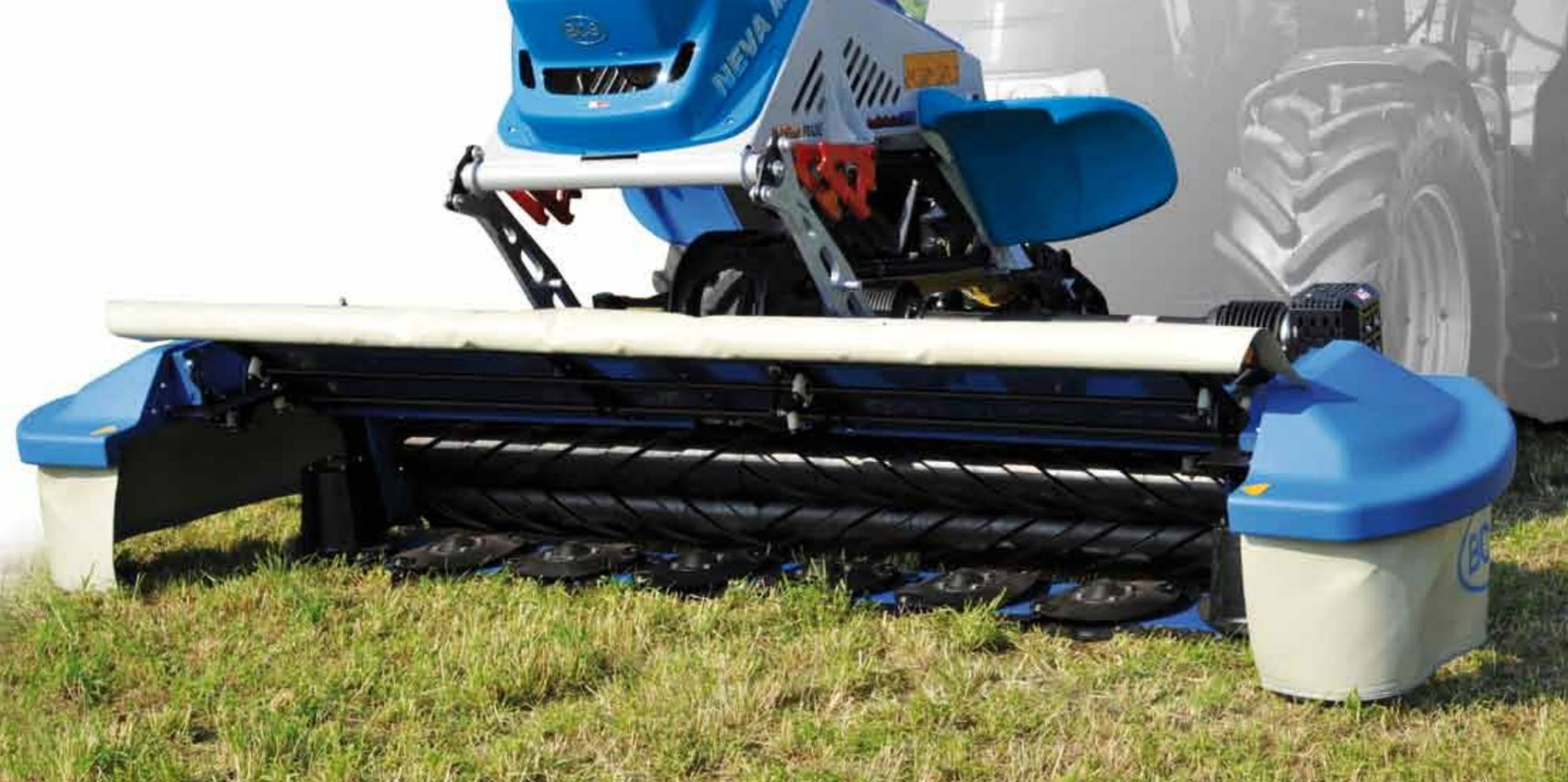
Tutte le barre falcianti adottano di serie il sistema di tenuta con guarnizioni toroidali e un sistema di sicurezza antiurto supportato da flange porta disco con limitatore coppia. Quest'ultimo garantisce la massima tutela della barra di taglio dagli urti accidentali che spesso avvengono durante il lavoro in terreni non bonificati, con gravi danneggiamenti degli organi interni.
