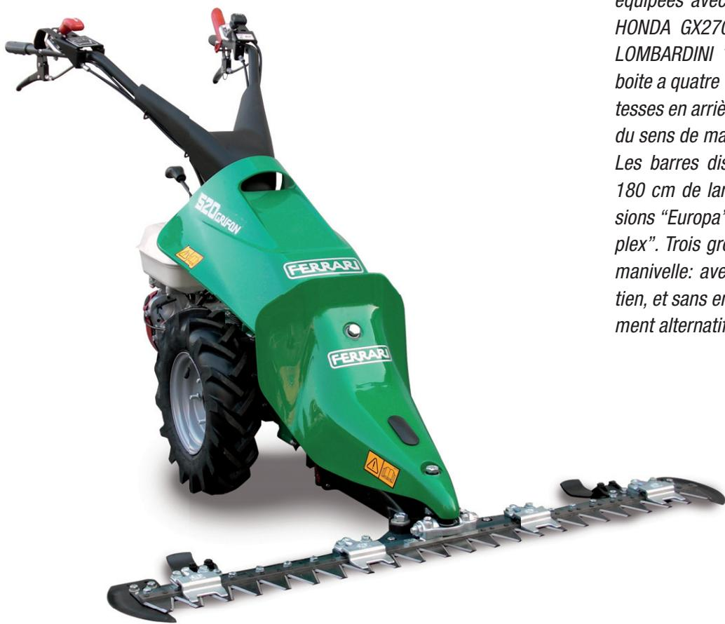
*Les motofaucheuses 520 Grifon sont équipées avec un moteur à essence, HONDA GX270 de 8 hp et un diesel LOMBARDINI 15LD350 de 7,5 hp. La boîte a quatre vitesses en avant et 3 vitesses en arrière, avec inverseur rapide du sens de marche.*
