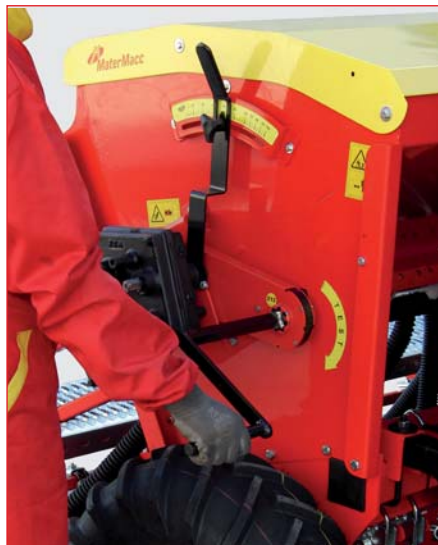
Variatore con manovella per prova di semina. Step-less CVT gearbox with seeding rate test handle. Stufenloses Ölbad-Getriebe mit Abdrehe-kurbel. Variateur avec manivelle pour essais de semis. Variador de velocidad con manivela para prueba de siembra. Вариатор с кривошипной рукояткой для пробного высева.
